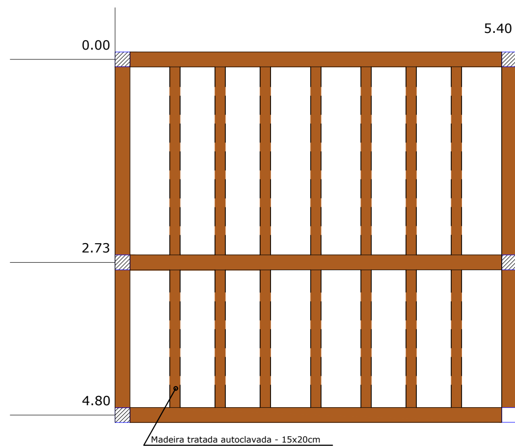
PLANTA DAS VIGAS AÉREAS DE MADEIRA ESC.: 1:75
